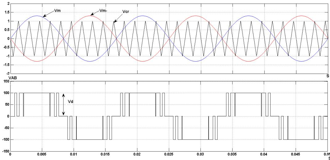
Fig. 17. Over-modulation ( $m=1.3$ ).
